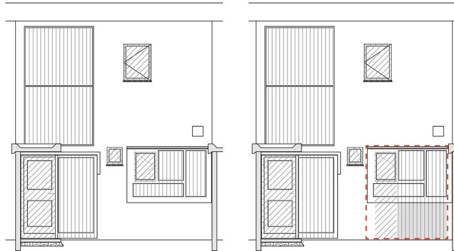
Ursprüngliche Befensterung der Nordfassade bestehend aus: Eingangstür mit festverglastem Element. WC - Fenster, zum Öffnen. Küchenfenster über massiver Brüstung mit 1 Öffnungsflügel und horizontal sowie vertikal, teils transluziden, fest verglasten Elementen. Im Obergeschoss rahmenlose Festverglasung im Treppenraum und Öffnungsflügel im Nordzimmer.
